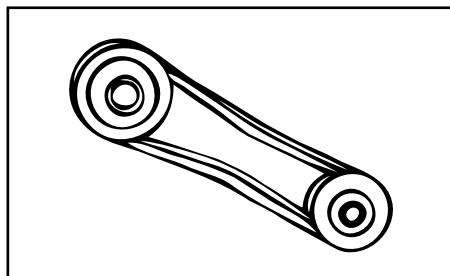
▶ сожмите ремень посередине между шкивами. Прогиб должен составлять не более 10–15 мм. Если прогиб отличается от указанного, измените натяжение ремня, для чего отпустите болты крепления двигателя и его перемещением обеспечьте правильное натяжение ремня. Затяните болты крепления двигателя.
