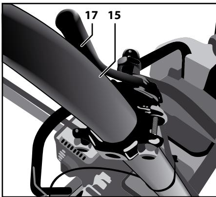
Закрепите на верхней части рукоятки рычаг **17** регулировки подачи топлива, стянув половинки хомута винтами, и зафиксируйте трос на рукоятке с помощью прилагаемых пластиковых хомутов.
