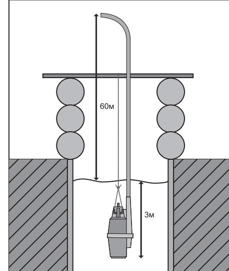
Для обеспечения свободной вибрации насоса, при высоте подвеса менее 10 метров осуществляйте подвеску на перекладину через эластичную проставку (резиновую полосу, шланг и т.д.). Установите на выходной патрубок **1** шланг (в комплект не входит) диаметром 3/4" и закрепите его хомутом или подсоедините трубопровод/штуцер диаметром 1/2" с резьбой.
