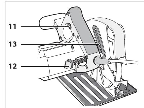
При необходимости ограничения глубины пиления, отпустите винт-барашек 12, отрегулируйте глубину пиления по шкале 13 и затяните винт.
