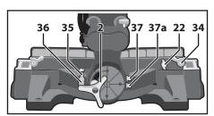
Ослабьте рукоятку 2 фиксации наклона пилы, приведите голову в вертикальное положение, отпустите стопорную гайку болта 35 и, используя угольник, установите пильный диск под углом 90° относительно поворотного стола 10 регулировкой упорного болта 35. Затяните стопорную гайку.
