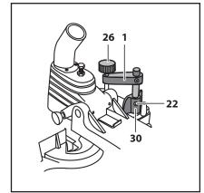
Для надежной фиксации заготовки при пилении на фронтальном упоре 15 предусмотрены гнезда 30 для крепления струбцины. Вставьте (кроме ЗПТ-190-1200 пл) стержень струбцины в гнездо и затяните винт 22 на задней стороне гнезда для закрепления стержня. Отрегулируйте струбцину в соответствии с размером и формой заготовки. Струбцина может быть установлена в упоре как слева, так и справа от пильного диска.
