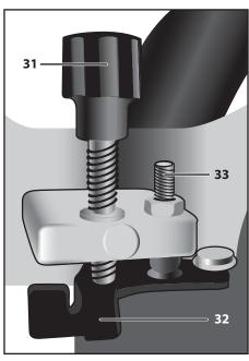
При необходимости ограничения глубины пиления (при необходимости разового пропила не на полную глубину заготовки или неоднократного пропила на заданную глубину) винтом 31 установите необходимую глубину пропила и зала или изготовления.
