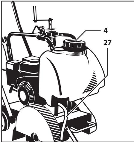
Для заливки воды, обеспечивающей снижение уровня пыли:
